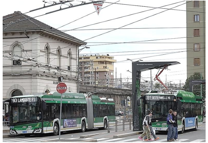
Trolleybus Solaris Trollino filaire et par recharge en station Smiley.toerist, CC BY-SA 4.0, via Wikimedia Commons
