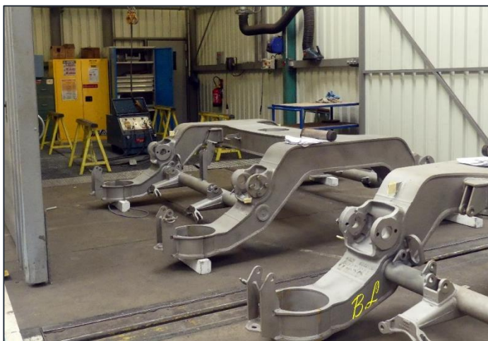
A gauche : les châssis de bogies mis à nu avant remontage (Photo Benoît Lemiale)
