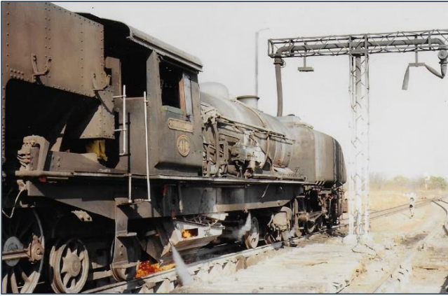
Sur la ligne de Bulawayo à Victoria Falls, entretien du feu et ravitaillement pour la 232+232 n°418 en gare de Matetsi
