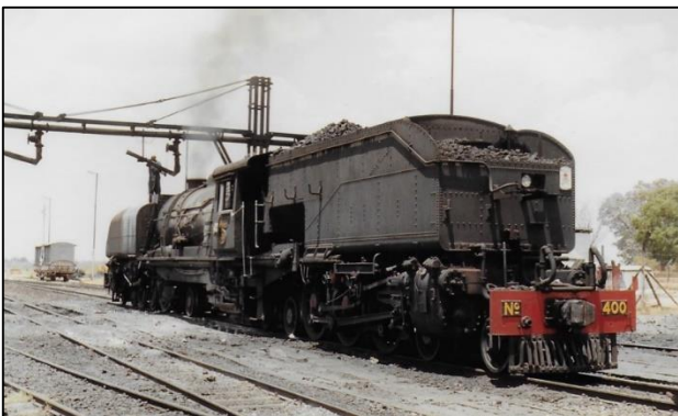
La même machine au terminus de Plumtree. Sur cette photo on distingue bien la différence entre le truck portant la soute à eau et celui portant la réserve de charbon.
