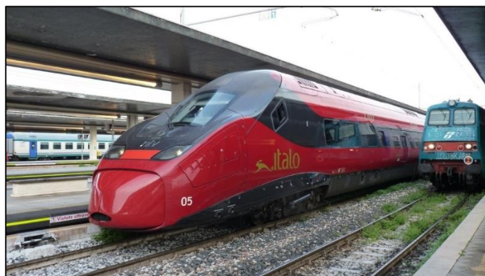
Et, toujours à Venise, le matériel « Italo » : ETR 575 à gauche et ETR 675 à droite : Les ETR 675 sont entrés en service depuis décembre 2017 et conçus pour une vitesse de 250 km/h.
