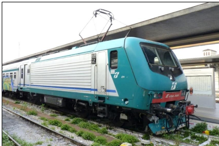
La E 464 – 309, construite par Bombardier. Ces machines sont équipées de l'attelage automatique, aptes à la réversibilité et prévues pour la vitesse de 160 km/h
