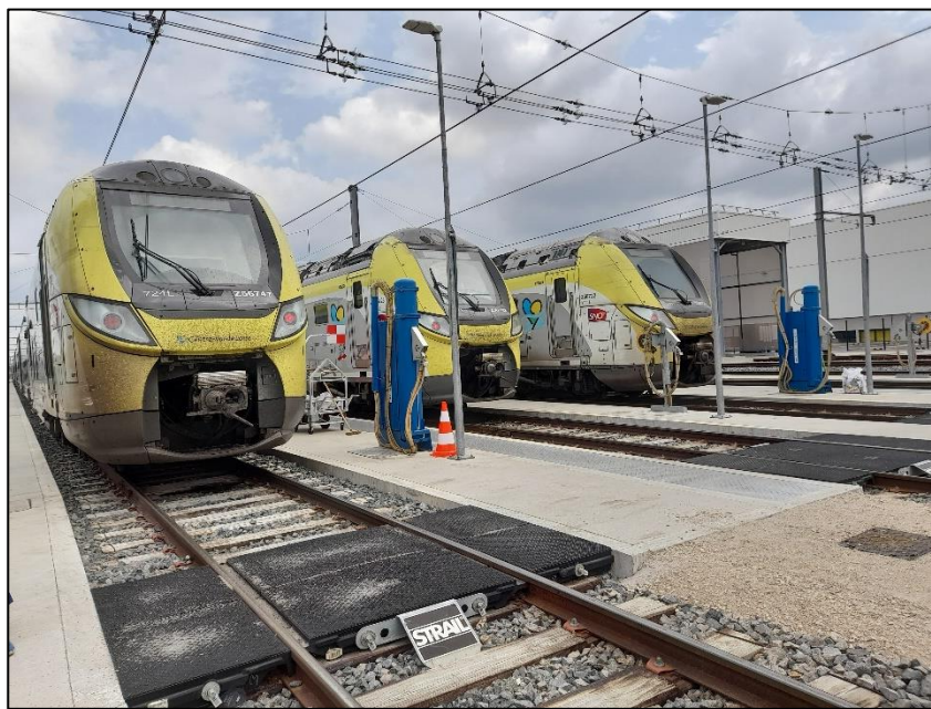
Les voies de stationnement du matériel régional, utilisées au ravitaillement en sable et nettoyage intérieur.
